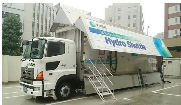
写真 2. 移動式水素ステーション
