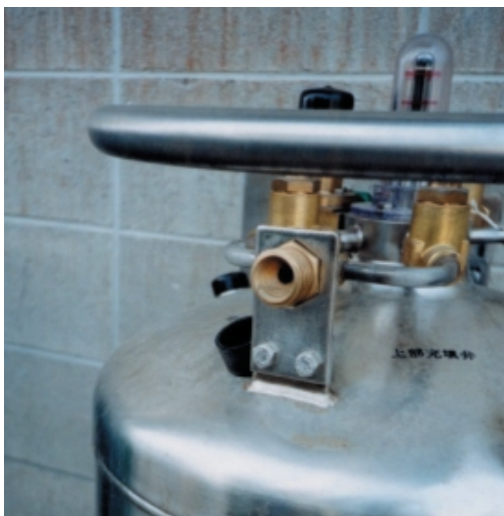
添付写真：LGC出口バルブ継手部分
