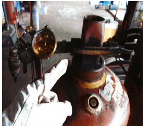
アセチレン調整器の点検不良による破裂・出火事例
