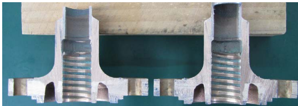
弁蓋部のネジ山が摩耗した事例
