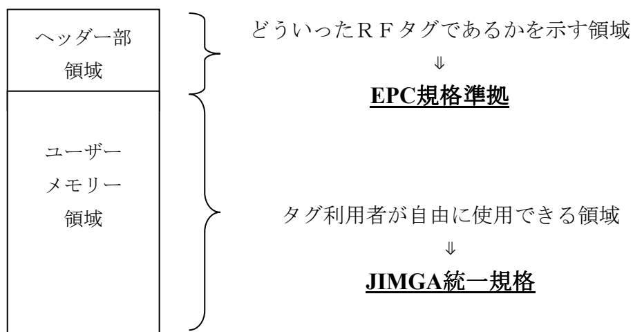
図5-2 RFタグ全体のメモリー構成概要
