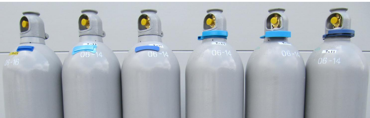
RFタグを装着した産業ガス容器 (左側3本:貼り付けタイプ、右側3本:ネックリングタイプ)
