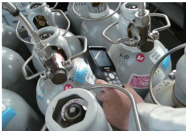
容器に装着されたRFタグとハンディーターミナル
