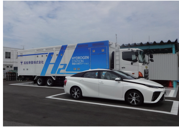
移動式水素ステーション
