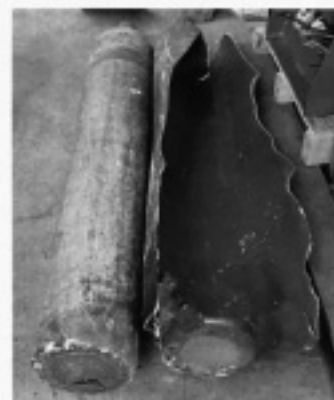
▲長期間放置により腐食し、破裂した窒素ガス容器
